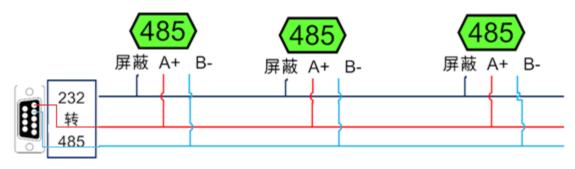
电脑自带的串口一般是 RS232,需要配 232-485 转换器(工业环境建议使用有源带隔离的转换器),转换后 RS485 为 A、B 两线,A 接板上 A 端子,B 接板上 B 端子,485 屏蔽可以接 GND。若设备比较多建议采用双绞屏蔽线,采用链型网络结构。
