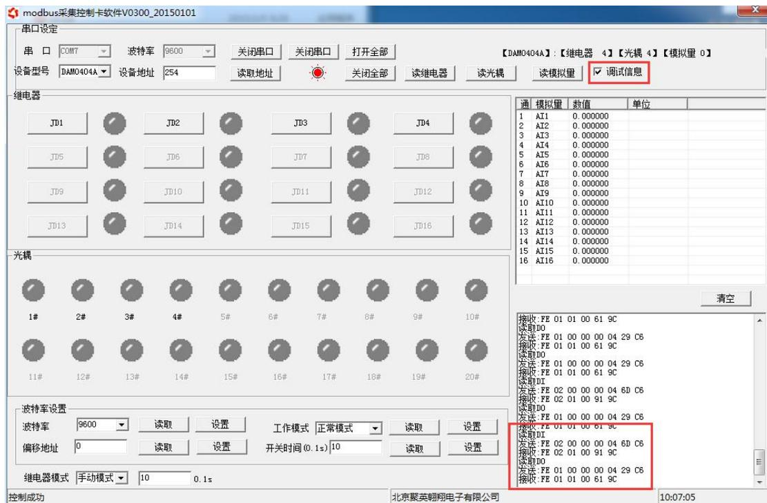
指令生成说明：对于下表中没有的指令，用户可以自己根据 modbus 协议生成，对于继电器线圈的读写，实际就是对 modbus 寄存器中的线圈寄存器的读写，上文中已经说明了继电器寄存器的地址，用户只需生成对寄存器操作的读写指令即可。例如读或者写继电器 1 的状态，实际上是对继电器 1 对应的线圈寄存器 0001 的读写操作。
