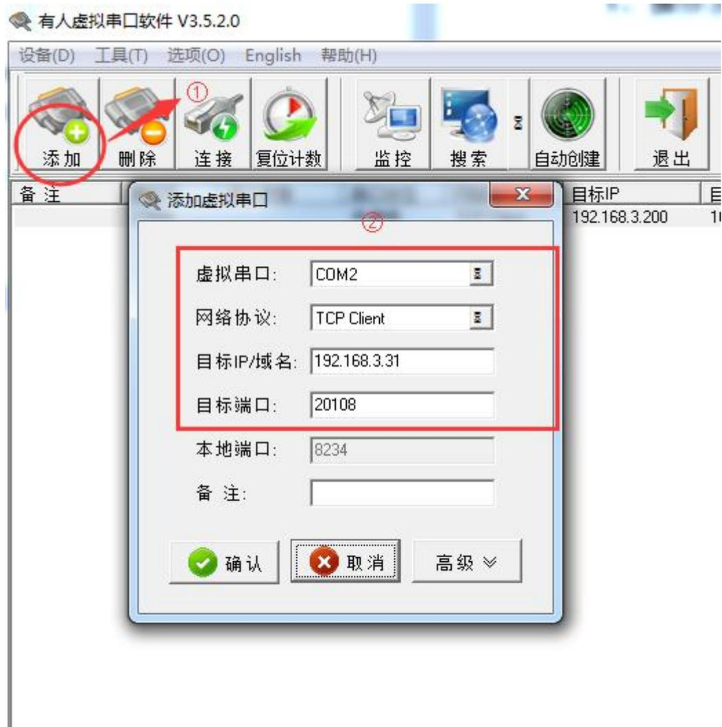
注：添加的虚拟串口不能与本机已有的串口冲突，目标 IP 即设备的 IP，虚拟串口参数要求与章节 4 中配置的设备参数一致。
